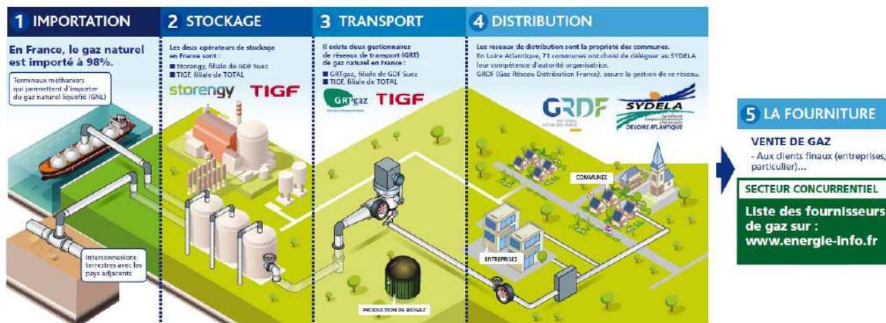
Figure 37 : Fonctionnement du réseau de gaz français, source : SYDELA – Syndicat d'énergie de Loire-Atlantique
